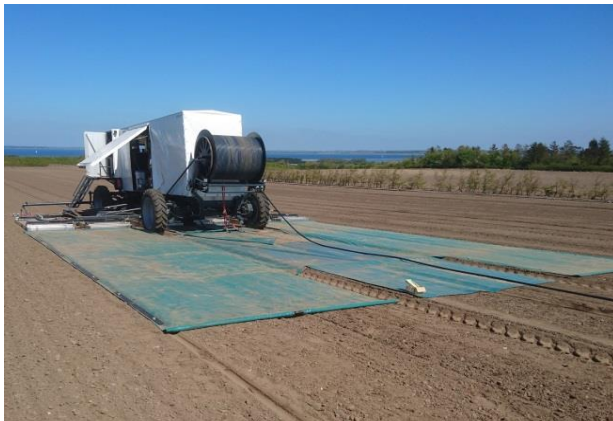
Bild 12: Zeyer Dampfgerät für 6 Beete, seit 2018 in Dänemark im Baumschuleinsatz
