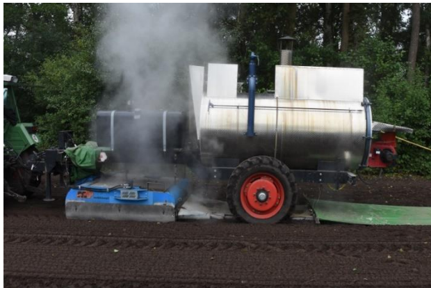
Bild 14 und 15: Mobildampfgerät mit modifizierter Egge, Lagerung außerhalb des Hitzebereiches
