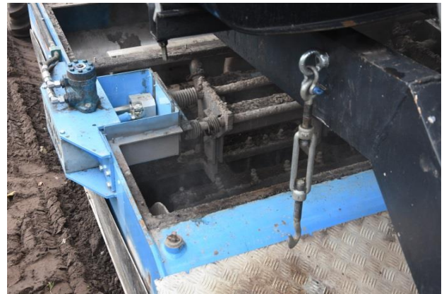
Bild 14 und 15: Mobildampfgerät mit modifizierter Egge, Lagerung außerhalb des Hitzebereiches
