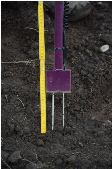
Bild 7 - 9: Verwendete Messgeräte zur Bestimmung der Bodenfeuchte, Bild links und Mitte Fieldscout, Bild rechts eine Gerät der Fa. Sartorius
